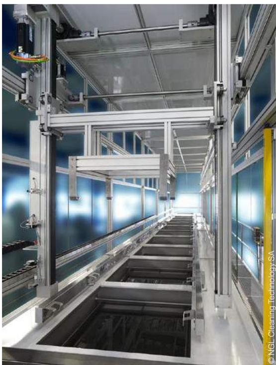
Installation automatique de nettoyage mise à disposition des clients pour la réalisation de tests.
