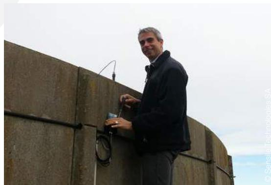
Installé par Cédric Morel, managing director de Sensile Technologies, ce système de mesure à distance émet une alarme en cas de baisse anormale du niveau de la citerne de purin. Il permet ainsi d'éviter la pollution de cours d'eau.
