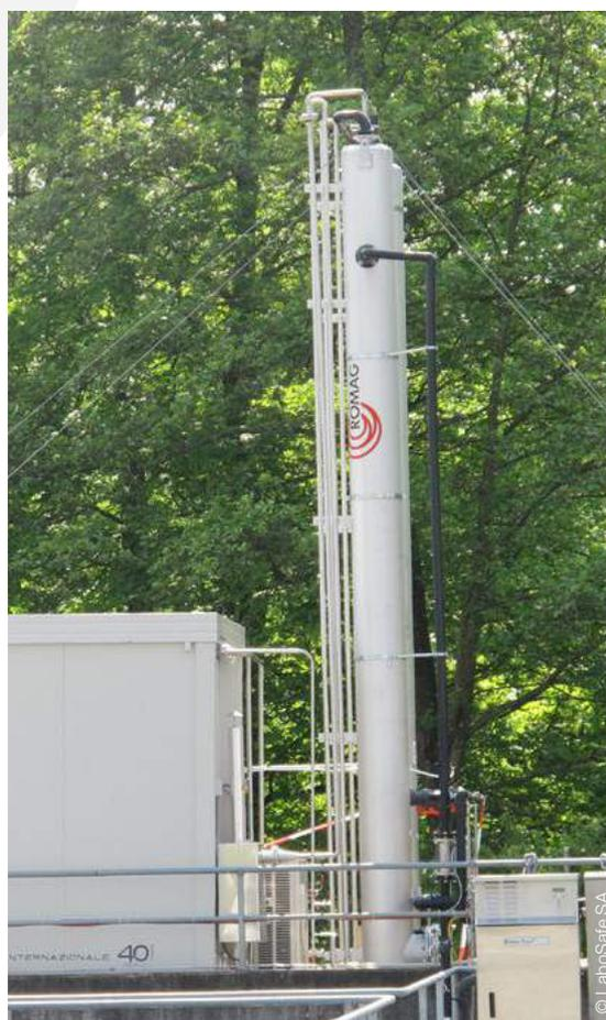
A Cham, LaboSafe a effectué un essai-pilote sur le traitement des micropolluants au moyen de l'ozone.
