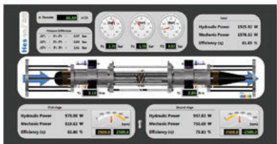
Interface Labview pour le monitoring d'une microturbine
