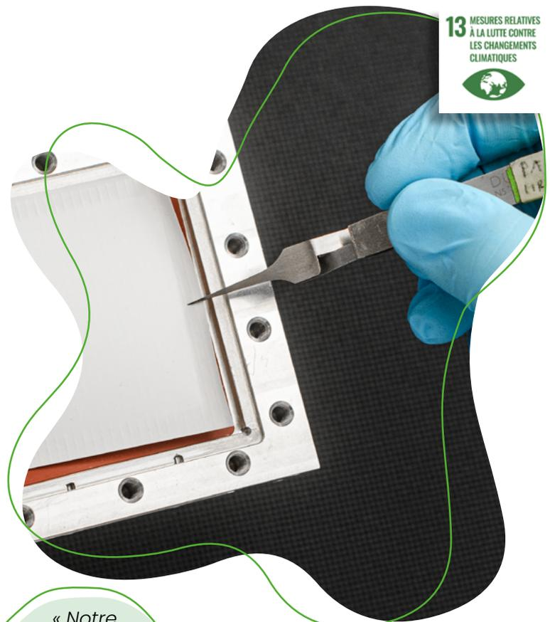
« Notre membrane en graphène est à la limite physique en termes d'épaisseur ; unique au monde, elle permet des installations de capture de CO<sub>2</sub> très efficaces et très compactes. »
